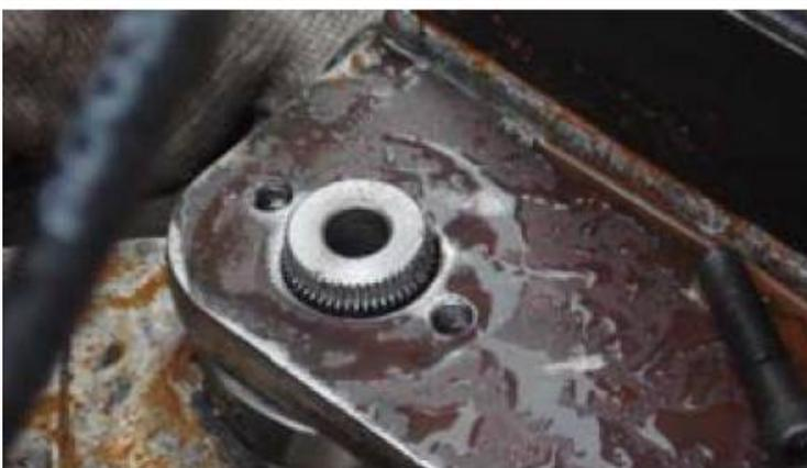
19. Установите подставки на лапы. Сначала разместите регулятор высоты под опору, а затем опору закрепите на лапе.
